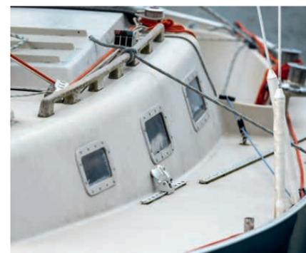
Zwei Vorsegelschienen erlauben guten Trimm, das hohe Cockpitsüll schützt sehr effektiv
